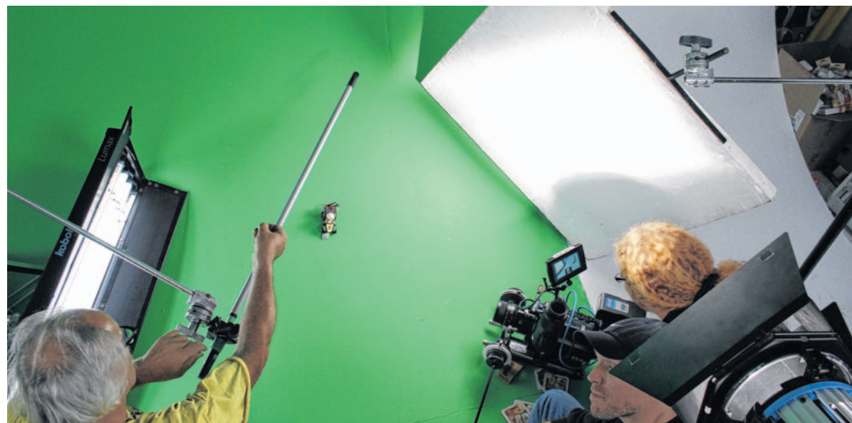
Green-Screen-Aufnahmeverfahren heißt es, weil man auf einer grünen Fläche dreht und letztlich dann Hintergründe beliebig hinzufügen kann. Unser Bild zeigt die Tüftelarbeit mit der Beleuchtung und der Spezialkamera. BILD: PRIVAT
